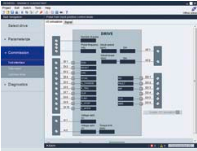
提供图形化的界面，用户直观地监测数字量输入 / 输出和其他控制信号的状态
